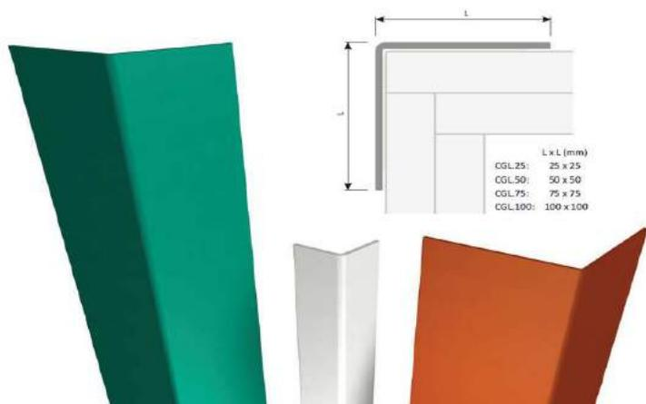
Profilo di protezione degli spigoli realizzato in materiale plastico antiurto spessore 2 mm colorato in pasta con finitura gofrata e da applicarsi sulla parete con apposita colla.
