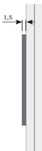
Piastra di protezione per parete realizzate in materiale plastico antiurto spessore 2 mm colorato in pasta con finitura gofrata.
